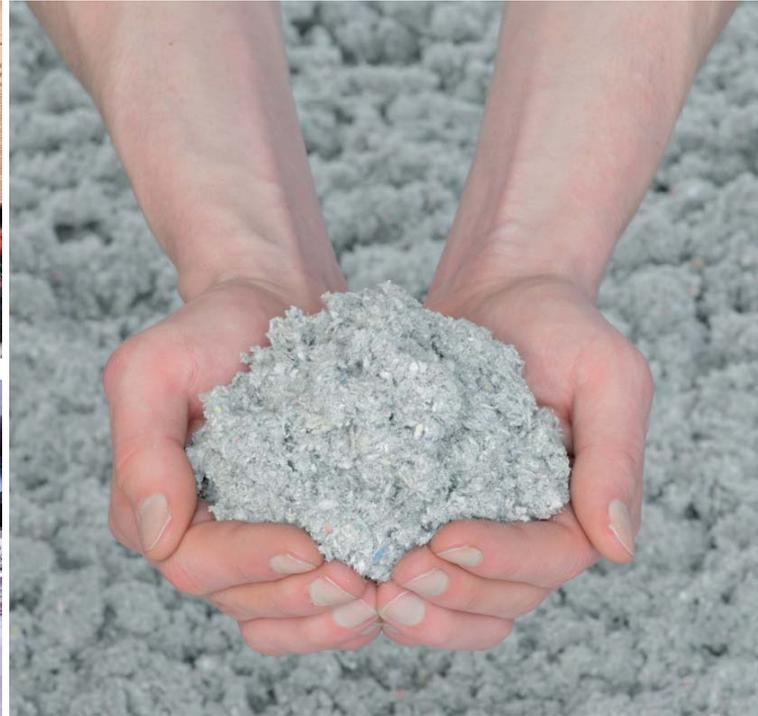
Die Produktion ist durch Fremd- und Eigenüberwachung für die deutsche, österreichische und europäische technische Zulassung strengsten Qualitätskriterien unterworfen. Die langfasrige Flocke überzeugt durch eine extrem **niedrige Wärmeleitfähigkeit** und **Setzungssicherheit** auch bei großen Dämmstärken.
