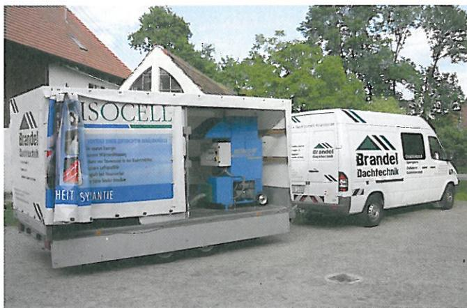
◀ Brandels Anhänger transportiert die Einblasmachine und dient als Werbefläche
